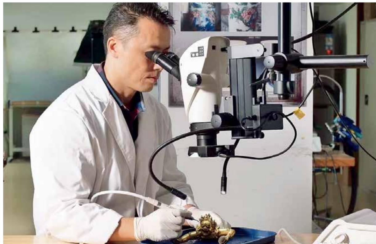
显微镜下对青铜器进行超声波清洗除锈
