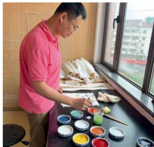
传统矿物颜料光老化实验样品制作
